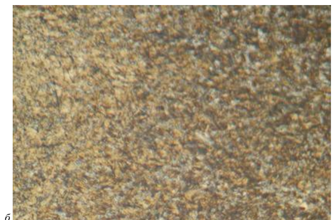
Рис. 1. Микроструктура стали 5ХВ2С после отжига (а), и ковки (б); \times 1000
