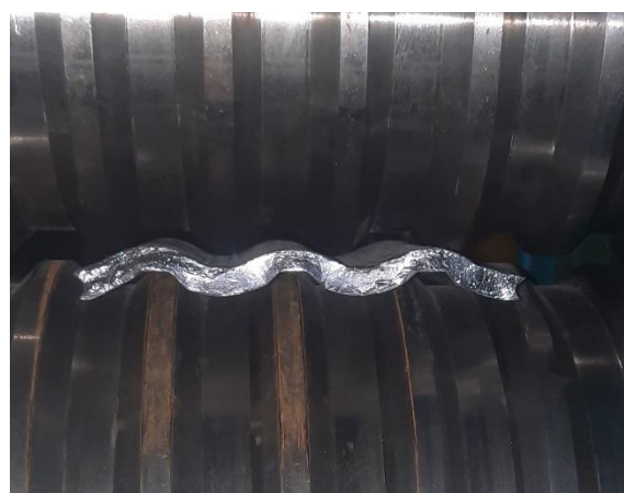
Рисунок 2 – Прокатка заготовки в рельефных валках
