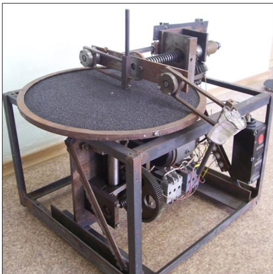
Рис. 1. Внешний вид лабораторной установки для измерения износостойкости материала
